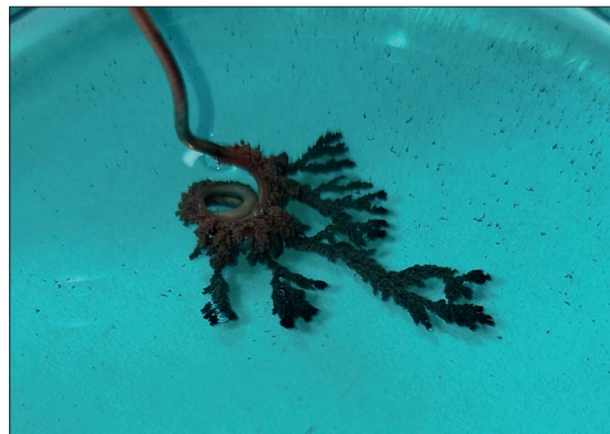
Obr. 4 Krystaly mědi vyloučené na měděné katodě (foto: Šmídl, 2022)
