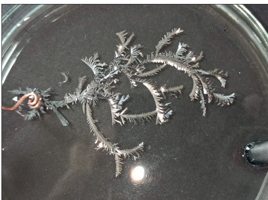
Obr. 1 Krystaly olova vznikající na měděné katodě z roztoku octanu olovnatého (foto: Šmídl, 2021)
