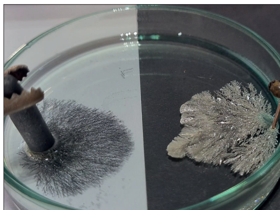
Obr. 2 Krystaly stříbra na katodě a stromčekovité struktury na grafitové anodě (foto: Šmídl, 2021)
