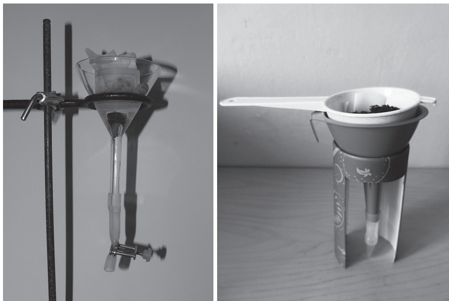
Obr. 3 Baermannova nálevka – vpravo profesionální varianta se sponou, vlevo domácí verze se zachytnou nádobkou z plastové zkumavky Eppendorf
