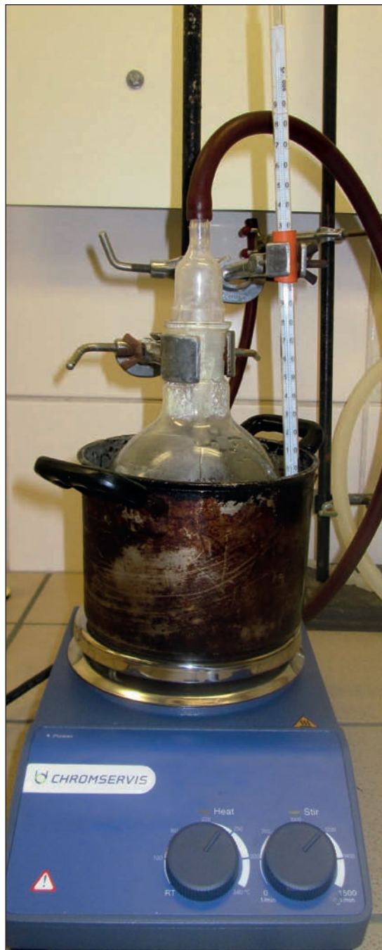
Obr. 3 Schéma aparatury pro přípravu pleuraxu, zdroj: autor
