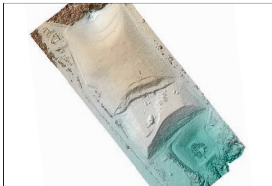
Obr. 17 Tieňovaný a ofarbený DTM skládky odpadov. Zelená farba predstavuje nižšie položené časti, tmavšia vyššie položené časti.
