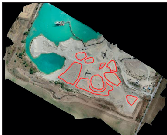
Obr. 20 Ortofotosnímka spracovaného územia. Červené polygóny na dne jamy predstavujú skladové zásoby vyťaženého materiálu, pre ktoré sa počítali objemy.
