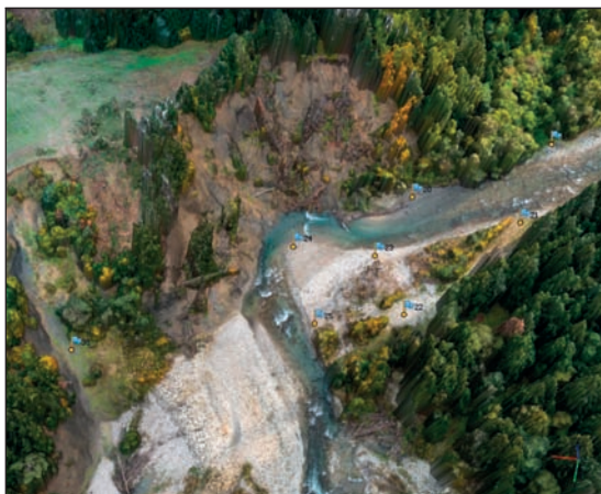
Obr. 9 Výrez z DTM zachytávajúci podtínaný svah.
